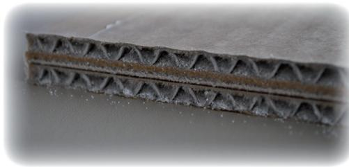
PhoneStar Schalldämmplatten bestehen aus umweltfreundlichen Materialien, Wellpappe und Quarzsand/Quarzstaub und werden nach einem innovativen Verfahren hergestellt.
