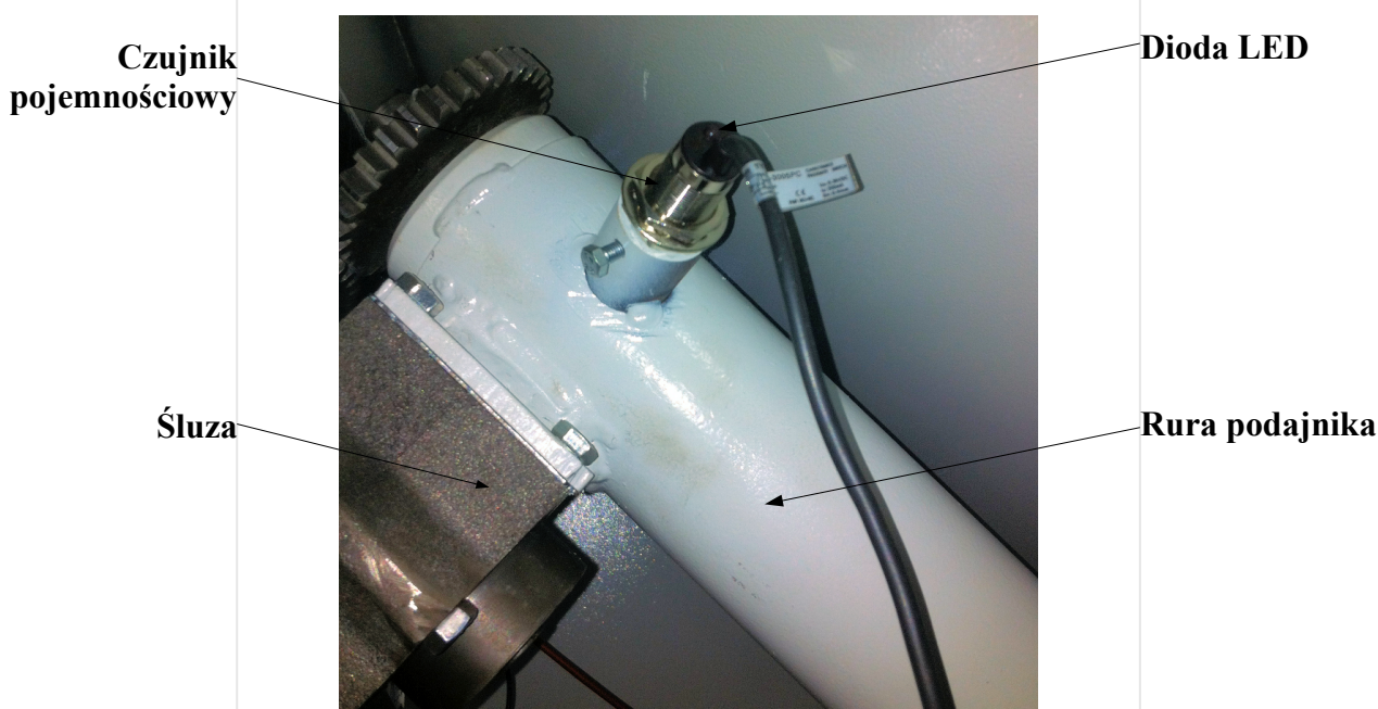
Rys nr 9. Umieszczenie pojemnościowego czujnika zbliżeniowego
